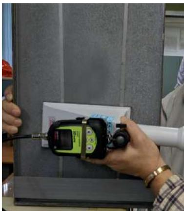
圖 8 Thermo BP-19BD 偵測模擬射源 (Co-60+鐵板)
