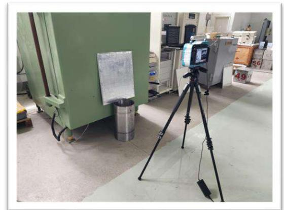
圖 1 極低微大面積面狀射源測試環境
