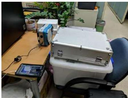
圖 5 H3D H400 偵測模擬射源 (Co-60+鋁箱)
