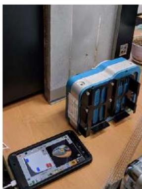
圖 13 H3D H400 偵測模擬射源 示意(Co-60+鐵板+鉛板)
