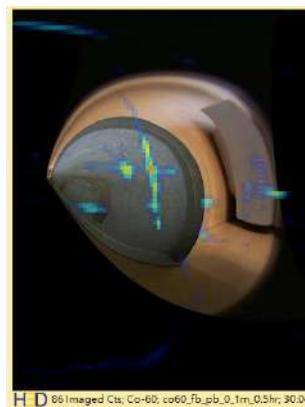
圖 17 熱點定位能力測試-0.1 公尺-0.5 小時-熱點判斷
