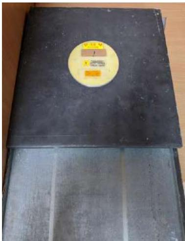
圖 1 Co-60 射源搭配鐵板及鉛板
