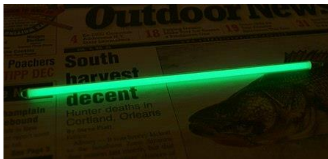
圖二 自動發光的氙燈 (含 670 億貝克氙，152.4 mm × 5.1 mm)
