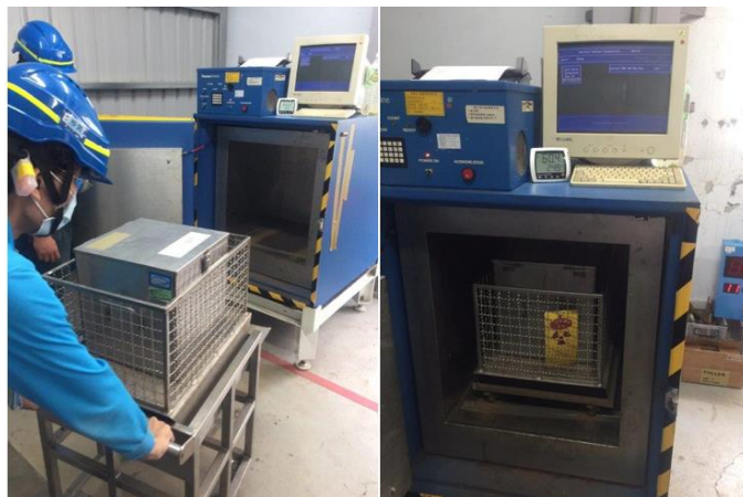
圖 1-箱型偵檢器量測裝填於容器中之待測物
