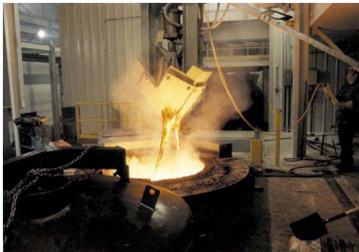
圖 2-對低程度污染金屬採熔煉法均化
